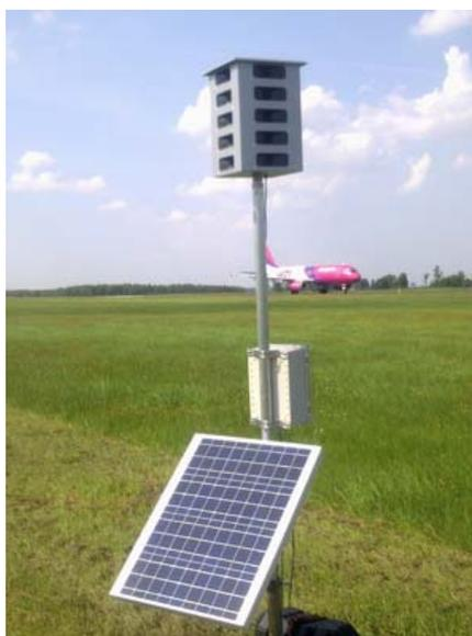
Рис. 3 — Биоакустическая система Bird Gard Pro Super AMP
