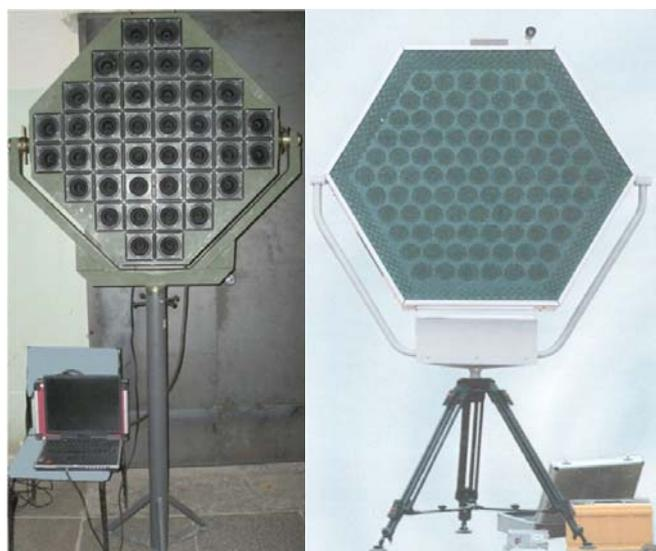
Рис. 4 — Установки акустического воздействия на основе излучающих систем АИ-40 и АИ-91
