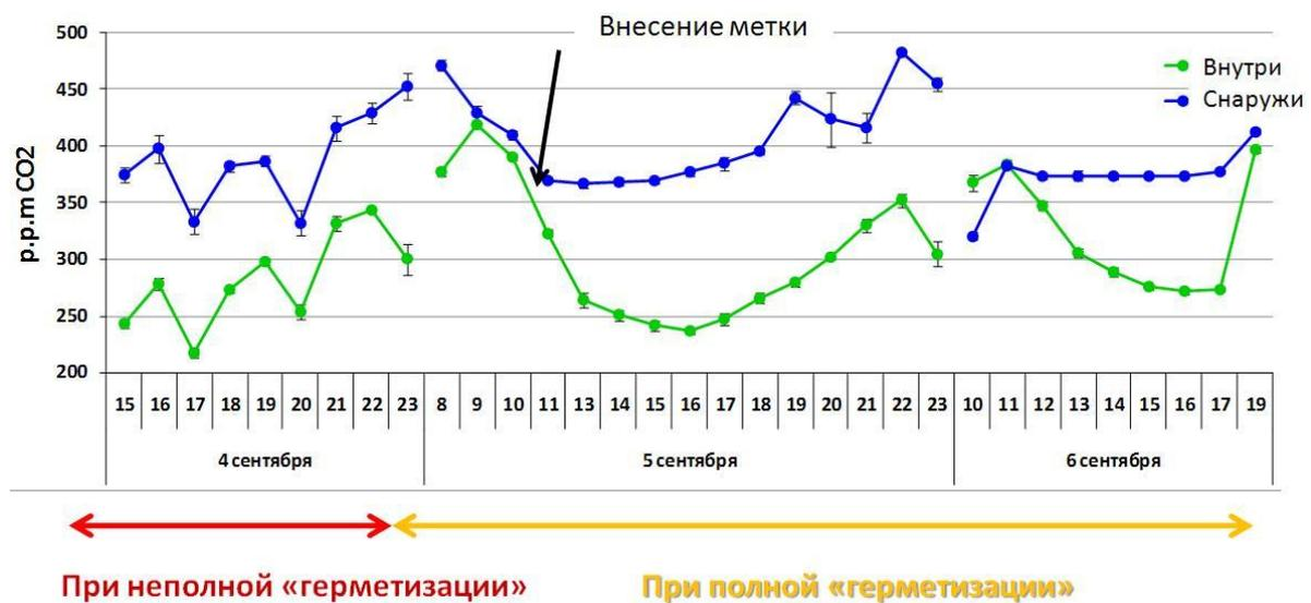
**Рисунок 2.5.** Динамика колебаний концентрации  $\text{CO}_2$  внутри и снаружи климакамеры.
