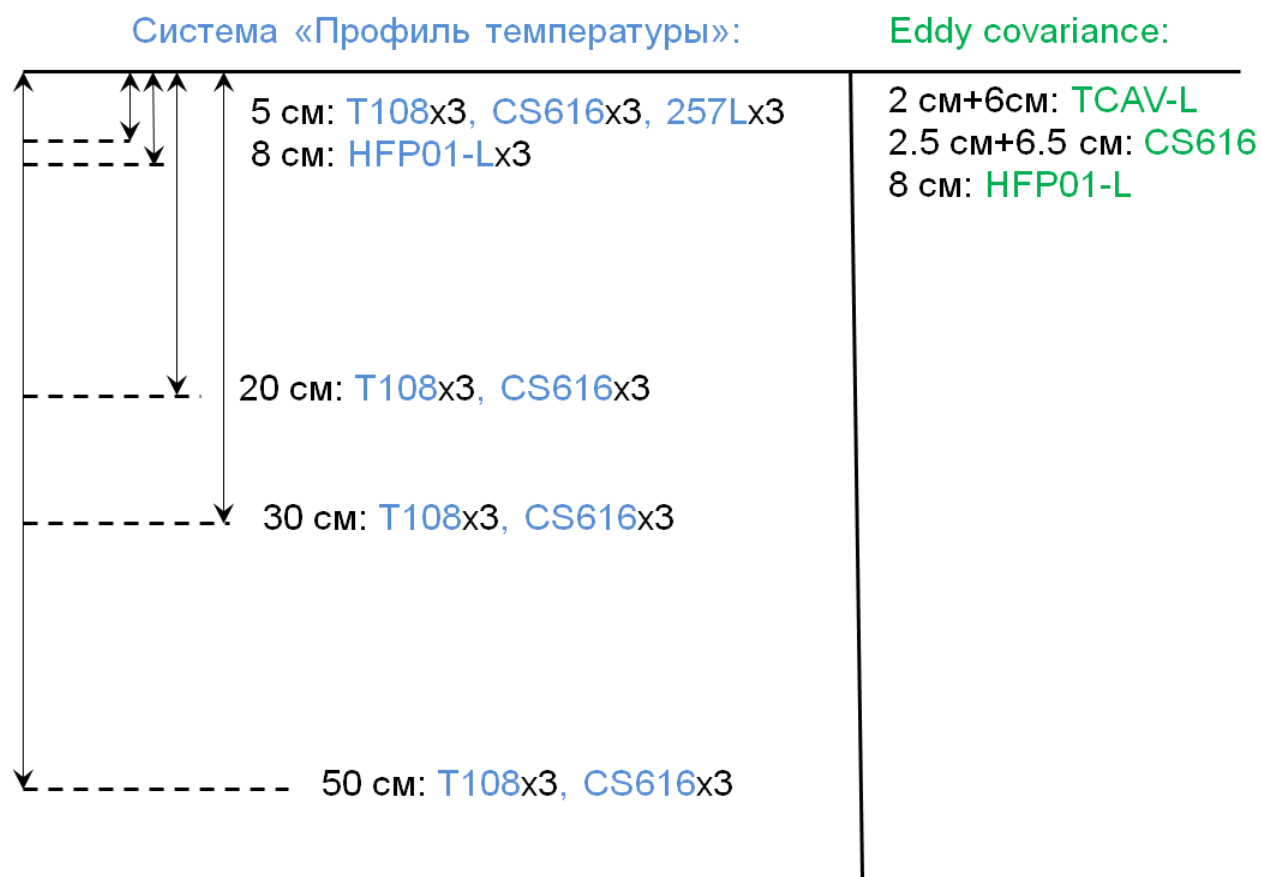
Рисунок 7 – Схема установки датчиков в почве
