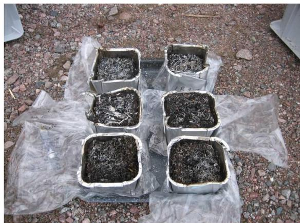
Рис. 12. Проведение эксперимента с выжиганием: (А) выжигание почвенной пробы в течение 1 минуты газовой горелкой, (Б) тлеющие пробы.
