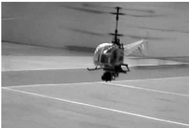
Рис. 2. Модель вертолета, оснащенная мини-видеокамерой.
